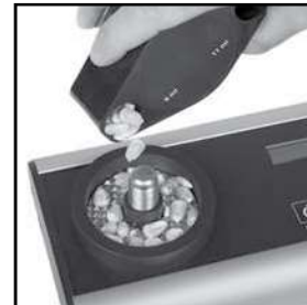
Figure 3. Pour grain into cell.
